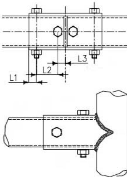
Die Schraubverbindungen Typ 1 (links) und 2 (links unten & unten) müssen für die Verbindung der oberen Teile des Hauptbügels, Frontbügels und der seitlichen Halbbügel verwendet werden.
